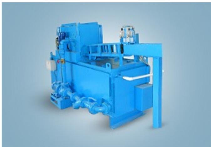
Машина для мойки и сушки роликовых подшипников предназначена для мойки буксовых подшипников качения. Процесс мойки включает в себя: мойку в моющем растворе и обдувку воздухом.
