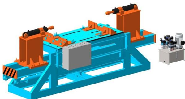
**Назначение:** Стенд предназначен для разборки электродвигателей, демонтажа щитов и удаления подшипников с ротора электродвигателя.
